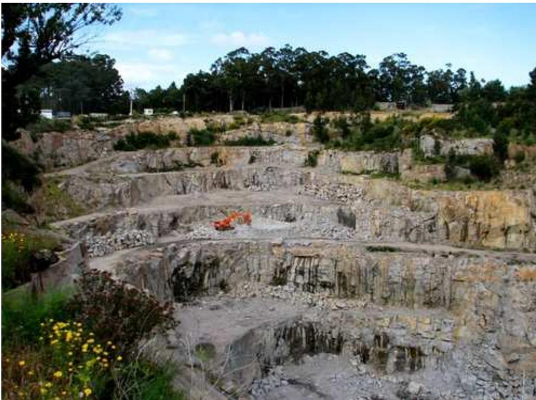
**Figura 54 - Imagem das bancadas de desmonte de uma pedra - Pedreira da Madalena, Gaia.**
