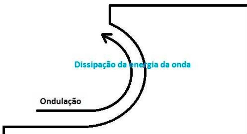
Figura 33 - Esquema de uma obra aderente em betão armado que permite a dissipação da energia das ondas devido a sua parede em forma cilíndrica.
