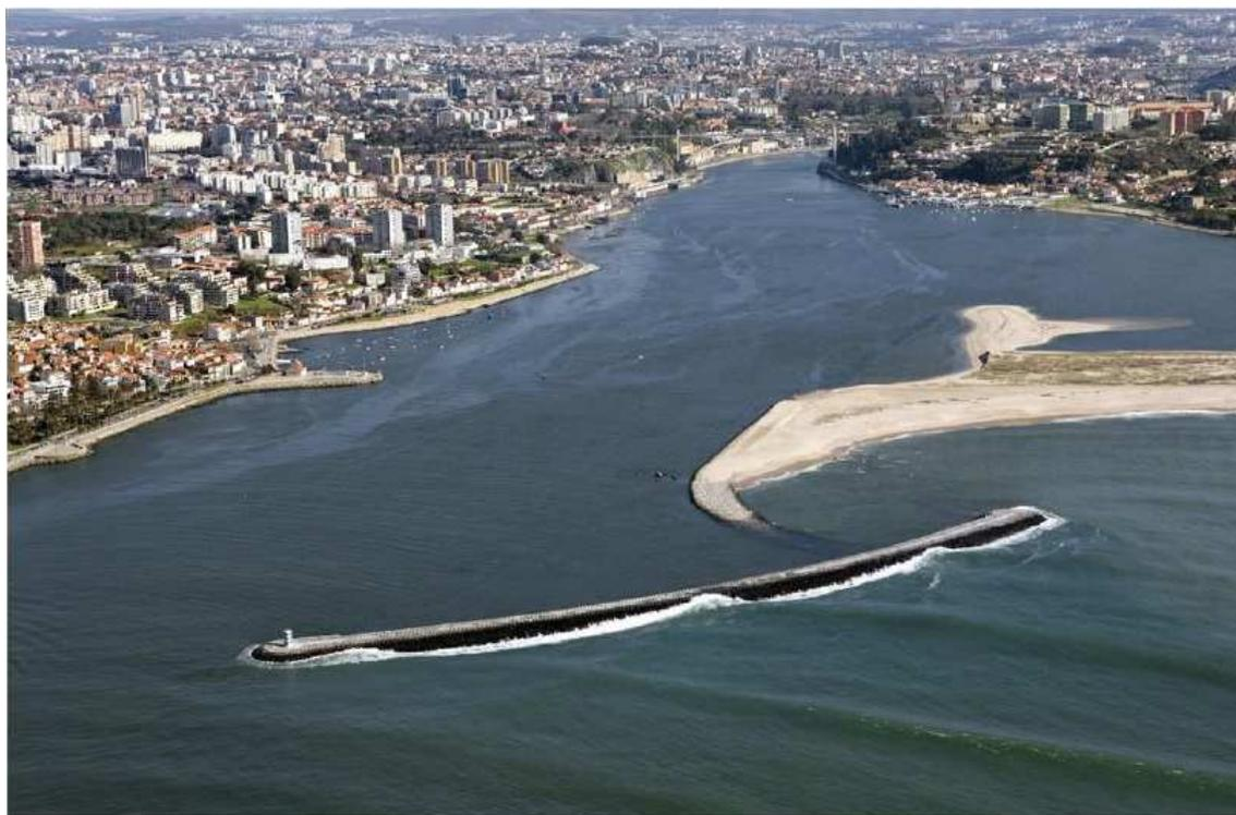
Figura 44 - Quebra Mar Destacado - Foz do rio Douro (Irmãos Cavaco, SA).
