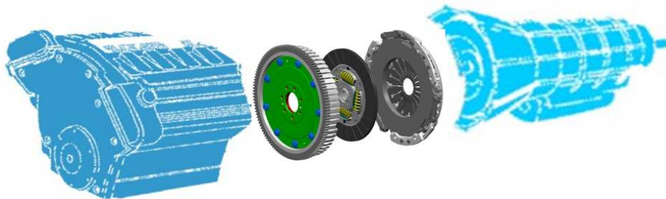
Figura 1.1: El embrague mecánico de un vehículo automóvil.
