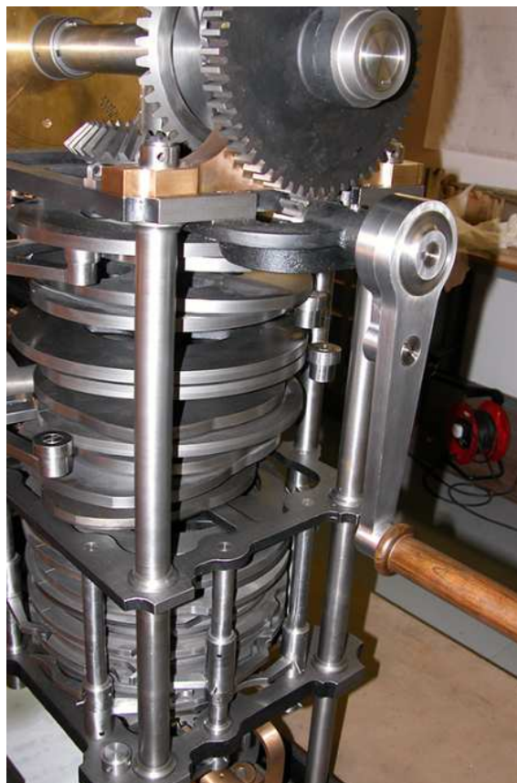
Fig.1.2: Detalle de la Máquina Diferencia N° 2. Museo de Ciencias de Londres.
