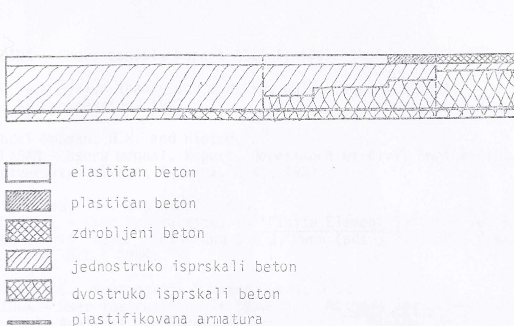
Sl. 5.11. Materijalno stanje po debljini ploče neposredno pred slom
