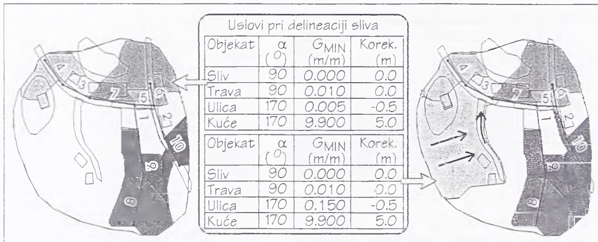
Slika 5.17: Primeri delineacije sliva: sa korektnim parametrima za kontrolu delineacije (levo) i sa nerealno velikom minimalnom vrednošću nagiba ulice (desno)
