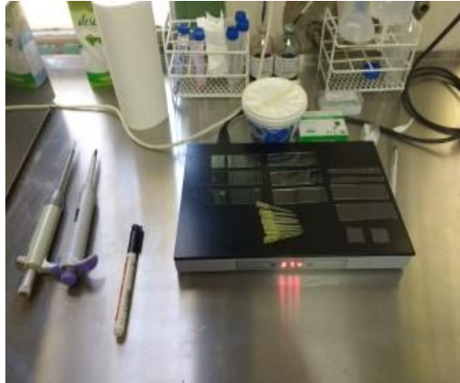
Platina térmica conteniendo materiales para el inicio del trabajo de coloración vivos/muertos
