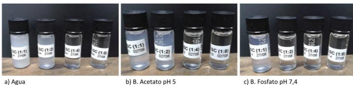
**Figura 39:** Fotografía de las muestras de Nanopartículas Mixtas. De izquierda a derecha, las relaciones PC: SC 1:1, 1:2, 1:4 y 1:8 preparadas en (a) Agua, (b) Buffer Acetato pH 5 y (c) Buffer Fosfato pH 7,4.
