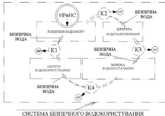
Рис. 4. Схема забезпечення якості води в системі водокористування з незалежними від негативної дії небезпечних речовин в надзвичайних ситуаціях функціональними властивостями: НР'НС – надходження небезпечних речовин в надзвичайних ситуаціях; K1, K2, K3, K4 – засоби запобігання, знешкодження та вилучення небезпечних речовин; НР – вилучені небезпечні речовини та продукти їх знешкодження
