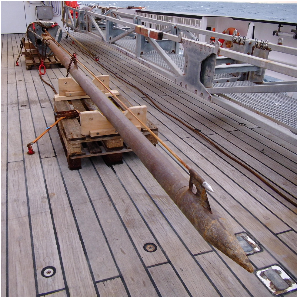
Fig. 6.7.2: 6 meter heat flow probe, from GEOMAR, Kiel
