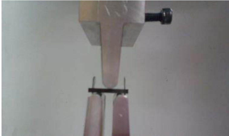
Abbildung 2.13: Einrichtung für den 3-Punkt Biegetest mit einem Probekörper
