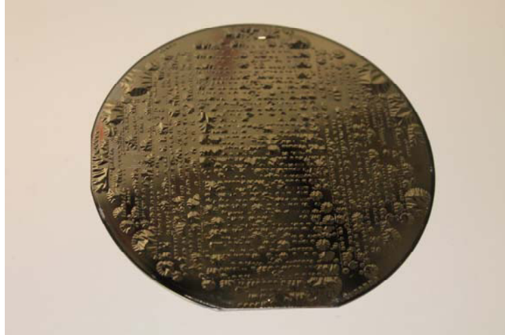
Abbildung 4.5: Wölbung der PI-Schicht nach dem schnellen Aufbringen von Cr-Ta 2 O 5 -Ta-Schichten
