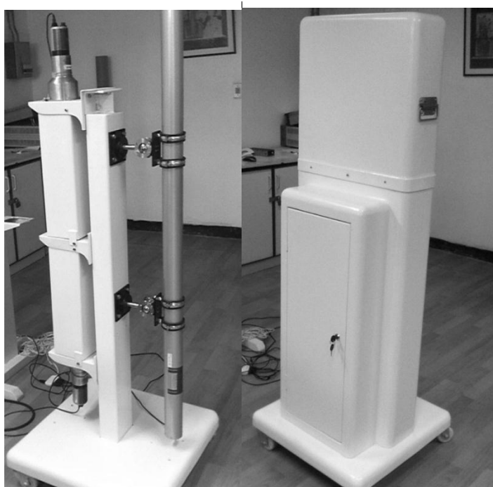
Gambar 8. Foto Tiang Statif Dan Sistem Casing.
