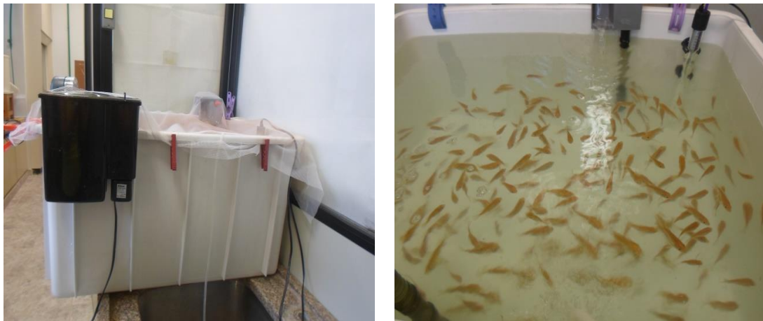
Fig. 6. Aclimação das tilápias em tanques plásticos com capacidade para 175 litros de água filtrada, aeradores e filtros. Temperatura da água mantida por termostatos a 28 \pm 2^\circ\text{C} sob luminosidade natural da sala.
