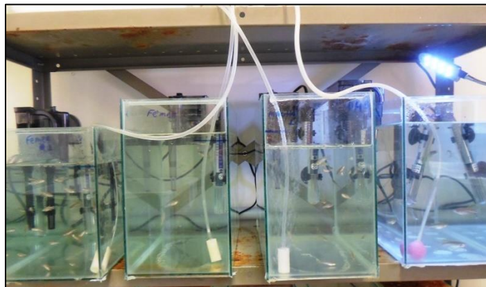
Fig. 7. Criação de zebrafish em aquários contendo 10 litros de água filtrada, aeradores e filtros. Temperatura da água mantida por termostatos a 28 \pm 2^\circ\text{C} sob luminosidade natural da sala.
