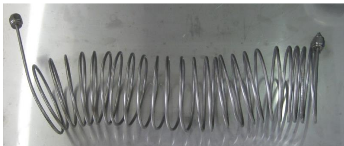
Figura 15 – Serpentina de refrigeração CO 2 .
