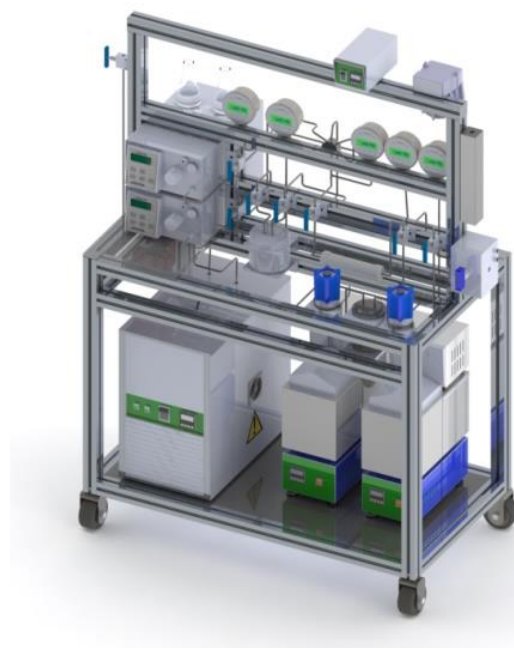
Figura 11 - Perspectiva da unidade de reações químicas em CO 2 supercrítico.
