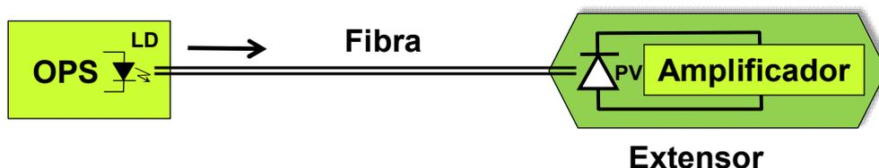
Figura5.2–Técnica *Power over Fiber* utilizada para alimentar um amplificador.
