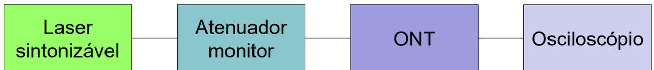
Figura 3.19 – Montagem experimental para avaliação da detecção dos comprimentos de onda nas ONTs.
