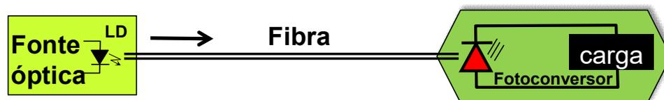
Figura 5.1 – Sistema PoF constituído de uma fonte de luz óptica- laser diodo (LD), fibra óptica e um fotoconversor
