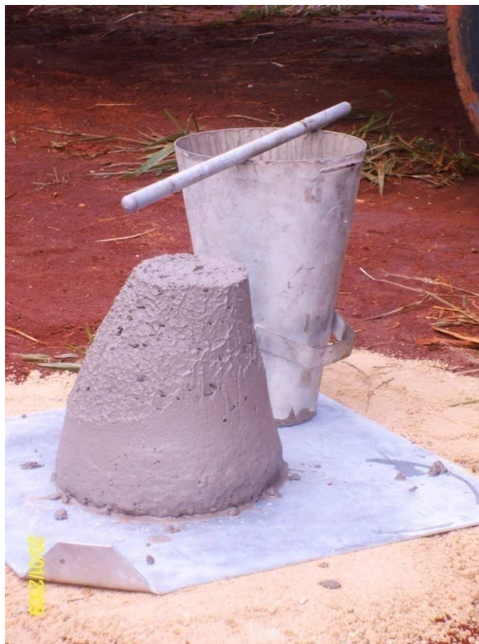
Figura 4.4. Ensaio de abatimento do concreto.
