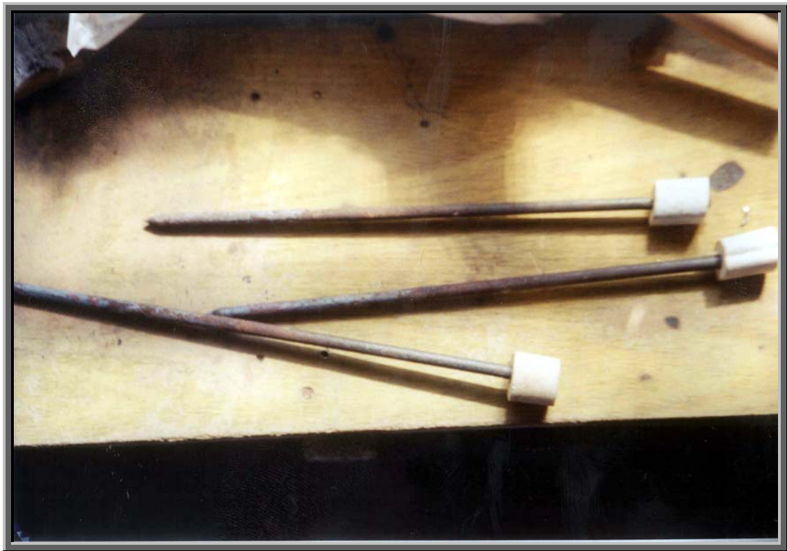
Fig. 39. Os “ferros de furação”, usados para construir os pífanos. As partes brancas são feitas de osso de boi e são colocadas para Sebastião segurar o ferro quente.
