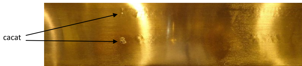
Gambar 5. Data pengamatan permukaan PEB U-7Mo/Al-Si No. 6
