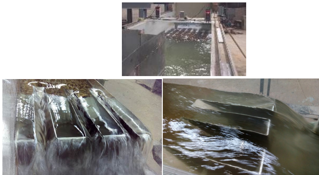
Figura 3 | Superior: vista del canal de ensayo desde aguas arriba del aliviadero. Inferior: ensayos de vertido sobre el aliviadero en tecla de piano base. Izquierda 32 l/s. Derecha: 74 l/s.
