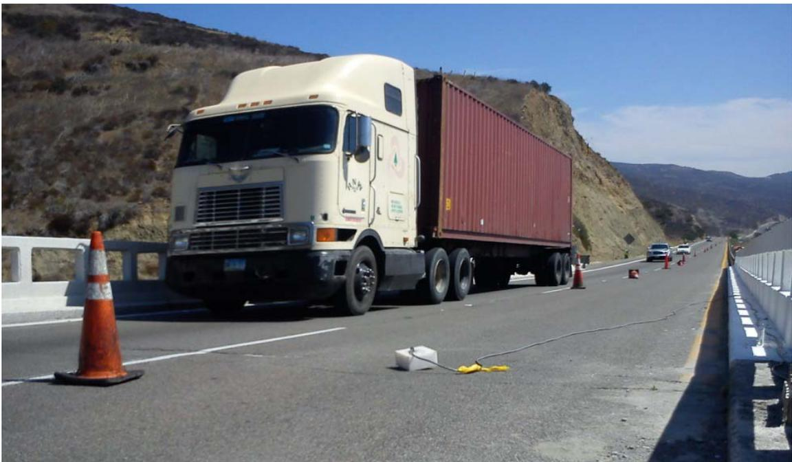
**Figura 17. Sensor ubicado sobre la superficie de rodamiento mientras el tráfico fluía por el carril contiguo.**
