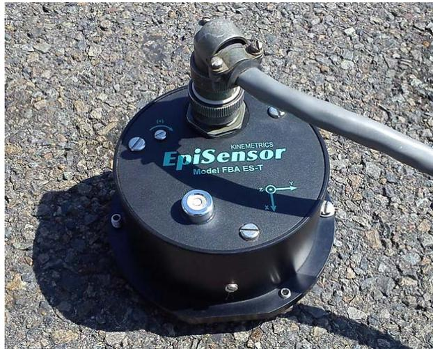
Figura 14. Acelerómetro triaxial EpiSensor FBA ES-T.
