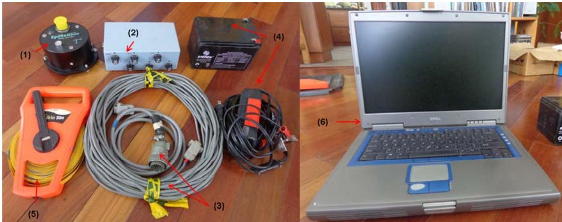
Figura 10. Equipo de medición: (1) sensor (2) interfase de conexión, (3) cables (4) batería y cargador y (6) laptop.
