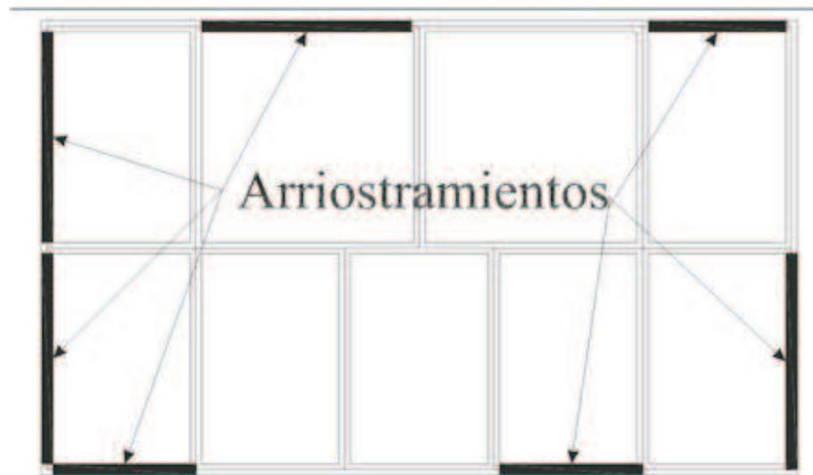
Figura 2.2: Disposición de arriostramientos disipativos en planta para una estructura de edificación
