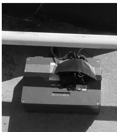
Figura 4.38 – Sismógrafo e unidade exterior de GPS.
