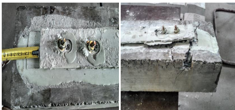
Figura 16 – En estos ensayos no se desprendieron las láminas, se verificó el ojalamiento de los agujeros.
