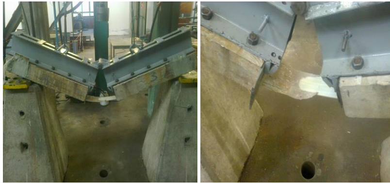
Figura 13 - Ensayos n° 3 y n° 4: Lámina con refuerzos de telas en los extremos despegue sin colapso pero sin resistencia resiliente
