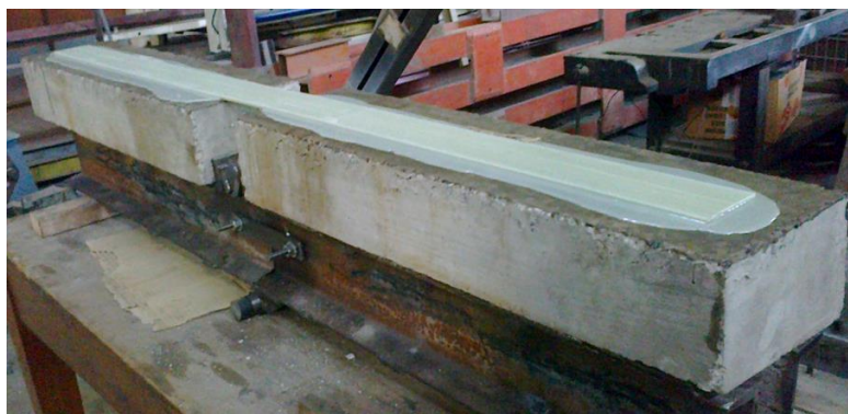
Figura 9. Sistema de anclaje a) lámina simplemente adherida
