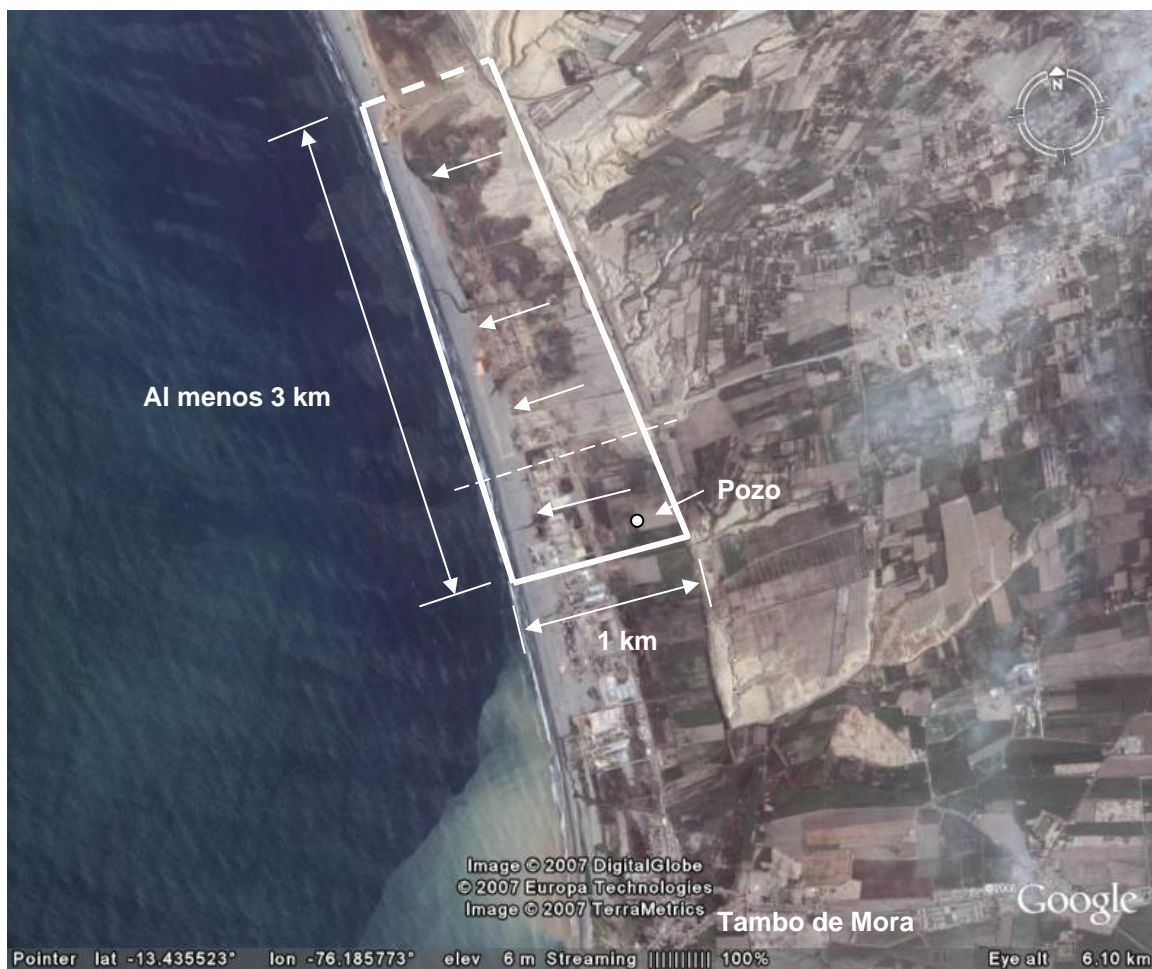
Figura 17: Desplazamiento lateral del terreno asociado a licuación en Canchamaná. Mapa base cortesía de Google Earth.
