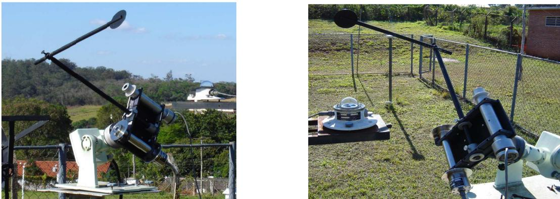
Figura 1. Pireliômetro Eppley NIP – Detector da radiação solar direta na incidência normal.
