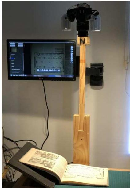
Figura 5: Modelo de escáner con cámara cenital
