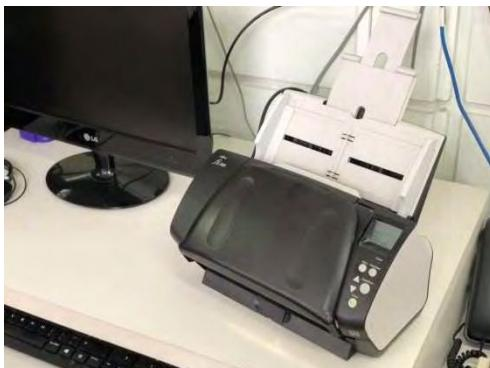
Figura 1: Hp 7500 Escaner con alimentacion automatica y cama plana.
