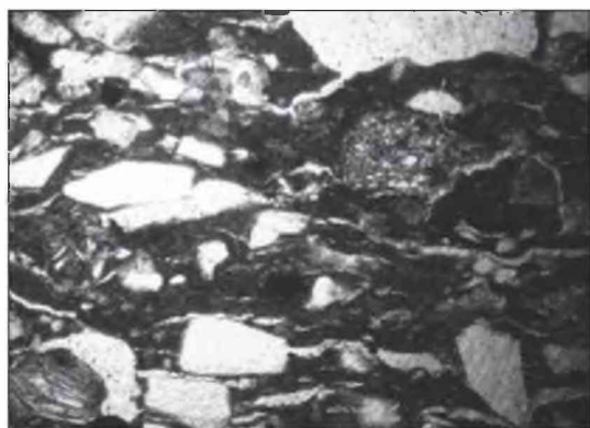
Figura 8. Fotomicrografía en nicoles paralelos (80x) de un sector de la pasta de un puco rojo pulido del Grupo 36 de Turi.
