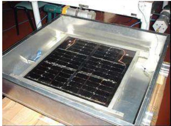
Figura 8. Cámara para inspección visual a 70°C
