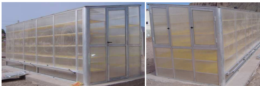
Figura 2: Vistas laterales del secador de policarbonato y aluminio.
