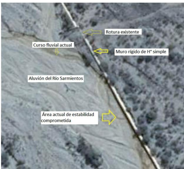
Figura 3 (izquierda). Muro en el río Sarmientos
