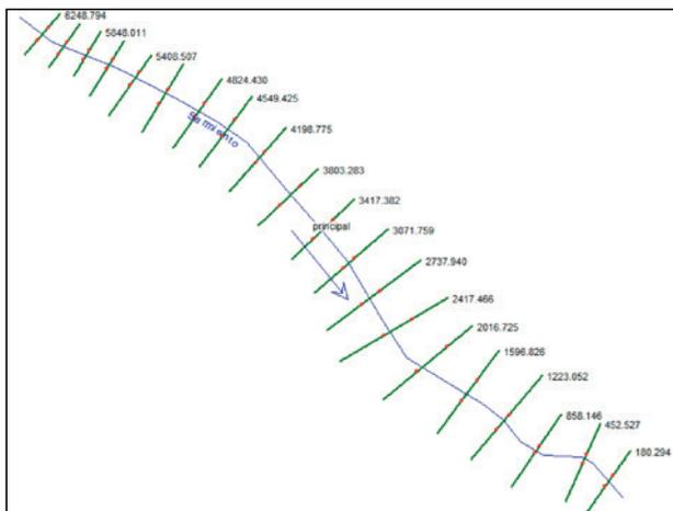
Figura 6. Modelo del cauce. Secciones transversales para el análisis de las velocidades de flujo contiguas al muro de H°
