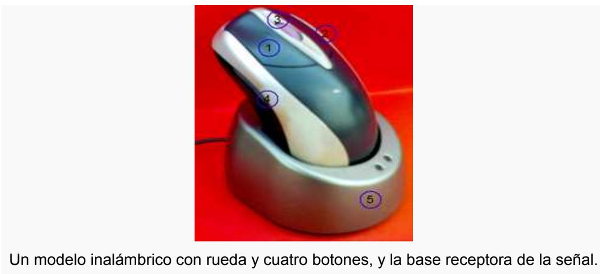
Un modelo inalámbrico con rueda y cuatro botones, y la base receptora de la señal.
