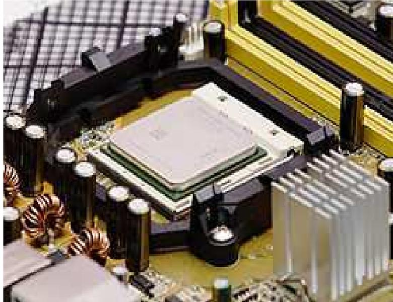
***Microprocesador de 64 bits doble núcleo***
