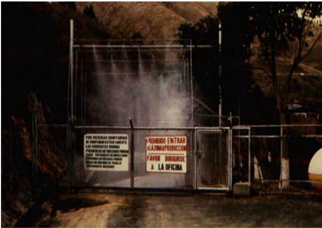
Foto 5. Rodoluvio en funcionamiento
