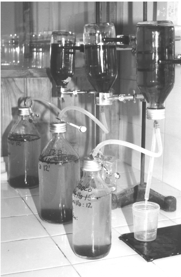
Foto 1. Sistema de medición de metano por desplazamiento de Hidróxido de Sodio
