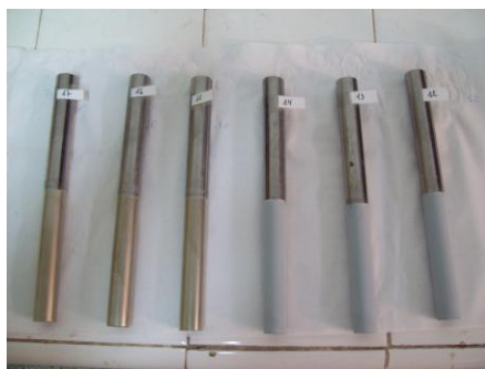
Figura 1; tubos de acero recubiertos con Zn en celda piloto.
