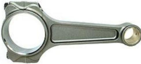
La biela original del motor tiene perfil H, mientras que la de competición perfil I, las bielas con caña perfil H son usualmente más rígidas y distribuyen mejor las cargas y las fuerzas de compresión que transmiten. Son ideales para ser utilizadas en motores de bajas vueltas.
