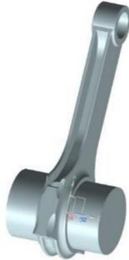
El caso simulado corresponde a una fuerza de tracción axial de 17648 N (Caso 8000 rpm) a la que corresponde una tensión de tracción de 92.68 MPa según el cálculo analítico.
