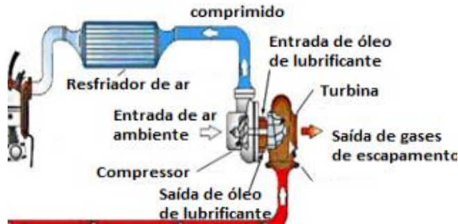
Figura 1. Funcionamento do resfriador de ar.
