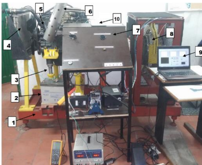
Figura 3. Vista del banco de pruebas con la consola de control y la instrumentación actualmente instalada en el laboratorio. 1- bancada, 2- batería, 3- torretas soporte, 4- radiador, 5- motor, 6- ducto de escape, 7- consola de control, 8- freno electromagnético, 9- consola virtual en software LabVIEW, 10- báscula.
