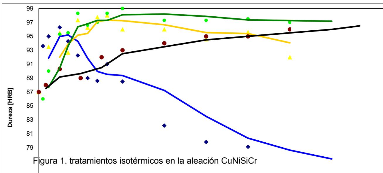
En cambio, en el tratamiento realizado a los 432°C, se alcanza el máximo de dureza a los 60 minutos y luego la dureza se mantiene aproximadamente constante hasta los 210
