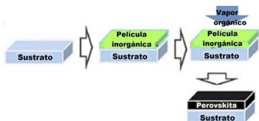
Figura 5 - Deposition de una capa de baja temperatura de perovskita mediante proceso de solución asistida por vapor [7].
