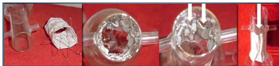
FIGURA 500. Oversizing mayor a un 20 % entre un modelo de cuello proximal de vidrio y un cuff aórtico. Obsérvese en las figuras de la derecha las «canaletas» que persisten luego de los intentos de planchado de la endoprótesis con el consiguiente endoleak tipo 1 proximal
