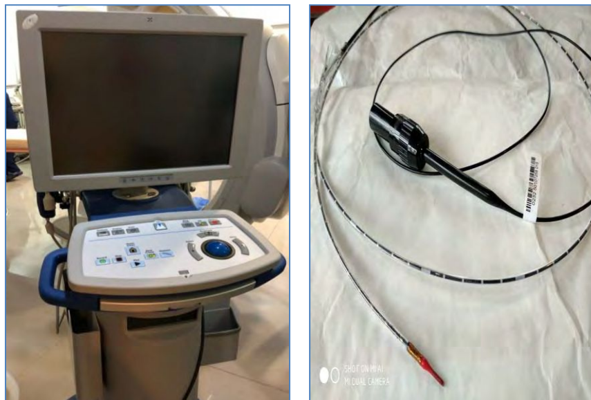
FIGURA 17 (B) y (C). Equipo Vulcano y cáteter milimetrado para uso de IVUS intraprocedimiento
