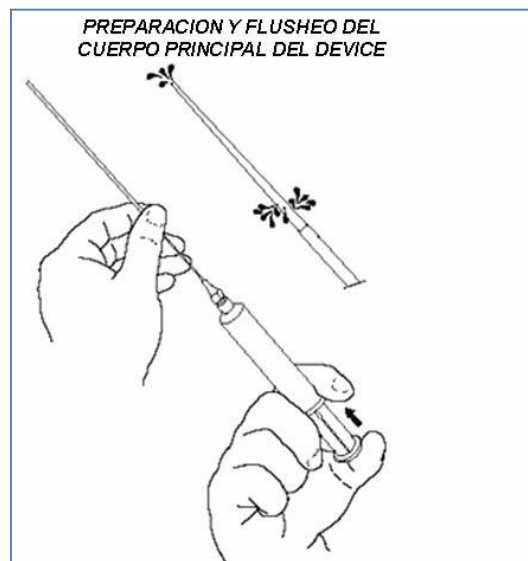
FIGURA 99. Preparación y «flusheo» del cuerpo principal del dispositivo
