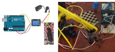
**Figura 12.** Prototipo de brazo robótico impreso en 3D + electroimán
