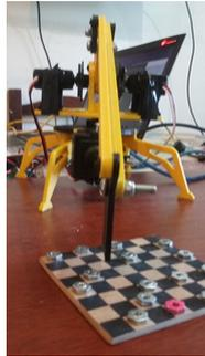
**Figura 11.** Prototipo de brazo robótico en 3D con tablero y ficha
