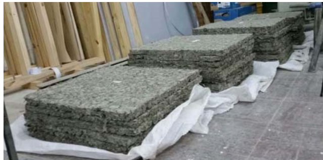
Fig. 5. Placas de cascarilla
