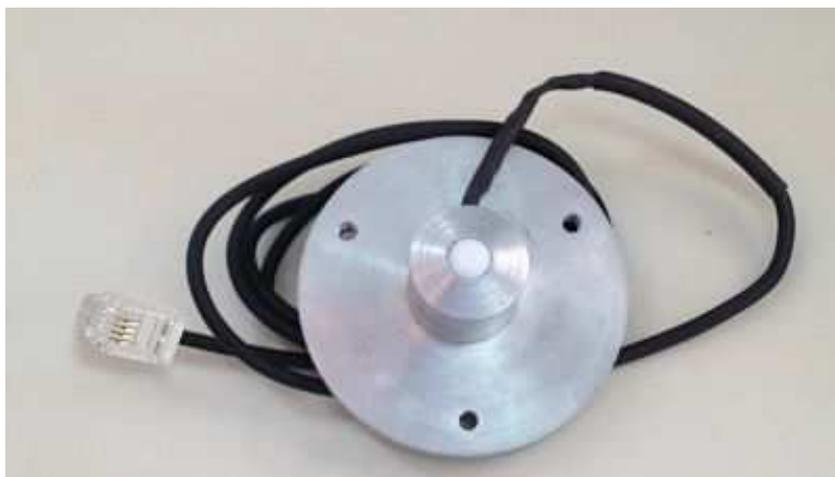
Figura 2: Foto del Piranómetro fotovoltaico construido.
