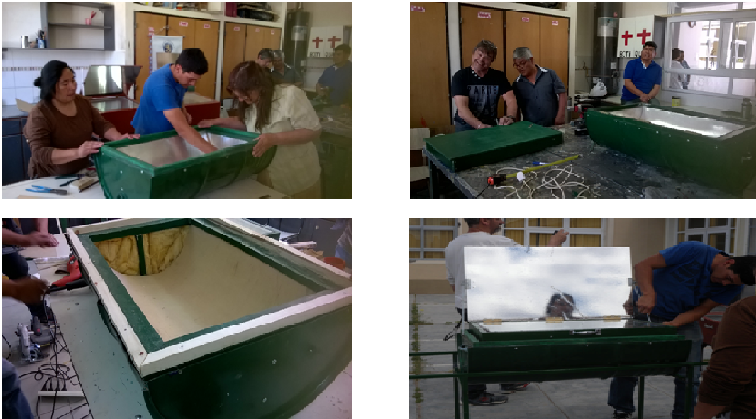
Figura 7: Armado de horno solar de tacho: colocación de aislantes térmicos, protecciones del aislamiento, inclusión de reflectores, etc.
