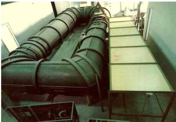
Túnel de viento con ambas secciones
