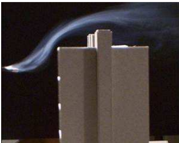
Figura 1. Ensayo con maqueta en el túnel de viento de baja velocidad, con gradiente de viento según altura sobre nivel del suelo.
