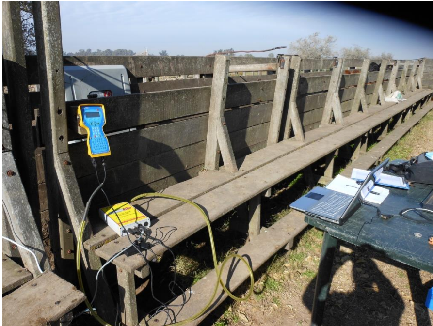
Figura 14: Imagen de la conexión de la antena fija amurada dentro de la manga a una computadora.
