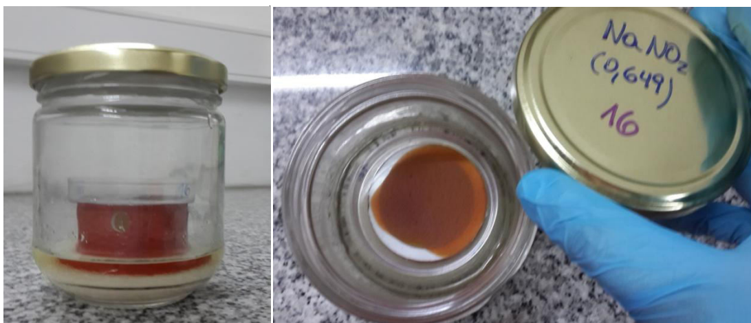
Figura 4. Sistema de actividad acuosa constante montado para la determinación de las isotermas.
