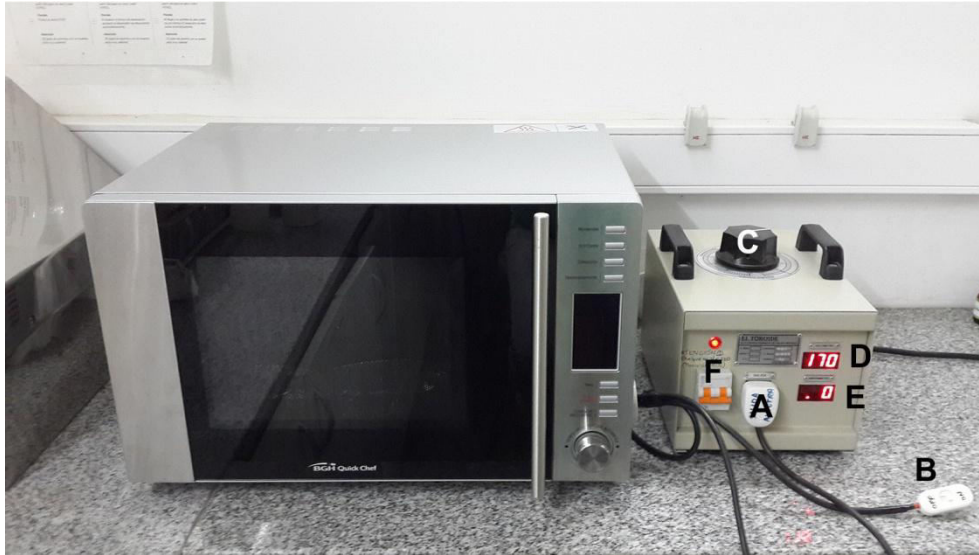
Figura 6. Horno de microondas (izquierda) y autotransformador de salida variable (derecha). A: conexión microondas-autotransformador; B: interruptor de convección del microondas; C: selector de tensión de salida; D: voltímetro; E: amperímetro; F: llave termomagnética de corte de salida.
