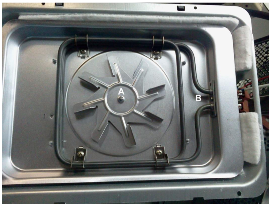
Figura 4. Parte trasera del equipo desmontada, donde se observan el ventilador posterior (A) y la resistencia (B) que fue desconectada.
