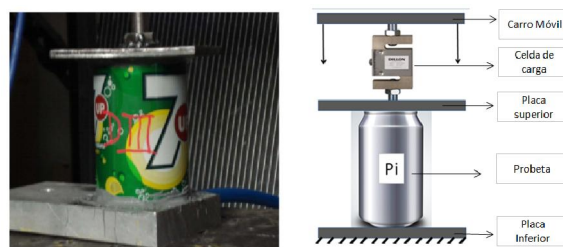
Figura 4. Probeta ubicada en banco, lista para ensayo
