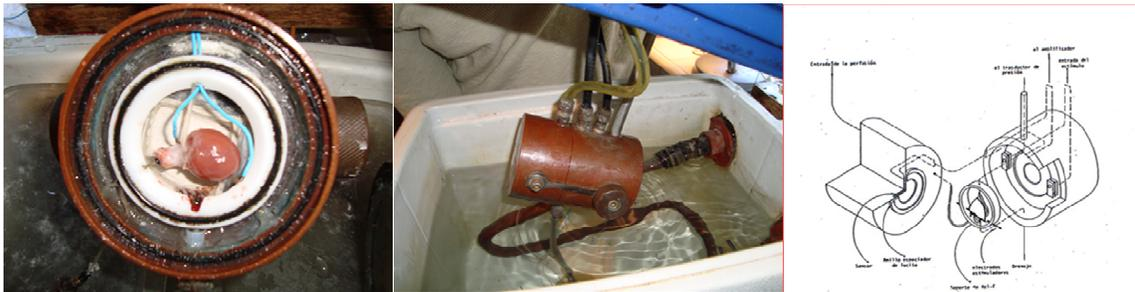
*Fig. 9: Foto del calorímetro y del montado del preparado (izquierda) y esquema del calorímetro de flujo (derecha) utilizado en esta tesis.*
