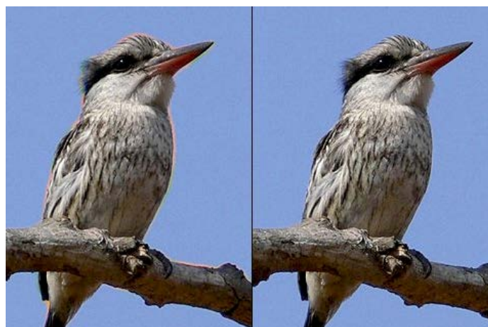
Fig. 3-58. La imagen de la izquierda fue obtenida con una lente acromática, mientras que la de la derecha fue capturada con una lente apocromática. Nótese la franja roja alrededor del pájaro y de la rama y el bajo contraste de la imagen izquierda. Si el fondo hubiese sido rojo, el halo de color sería verde o azul. La imagen de la derecha no muestra aberraciones. Obtenidas de: http://www.company7.com/leica/telescopes/digiscopy.html
