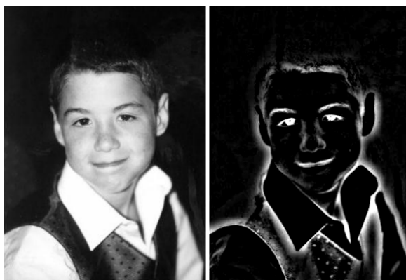
Fig. 4-80. Aplicación del filtro espectral grande para enaltecer bordes sobre un fondo oscuro. Se utilizó un kernel de 27x27 en un solo pasaje.
