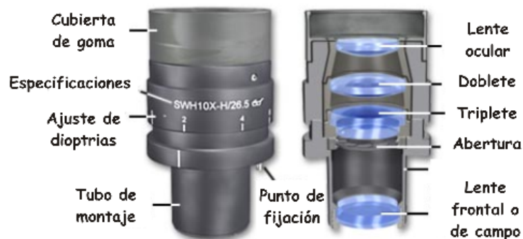
Fig. 3-82. Inscripciones externas del ocular y corte sagital mostrando el interior del mismo.
