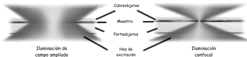
Fig. 3-29. Iluminación de la muestra mediante campo ampliado y confocal.
