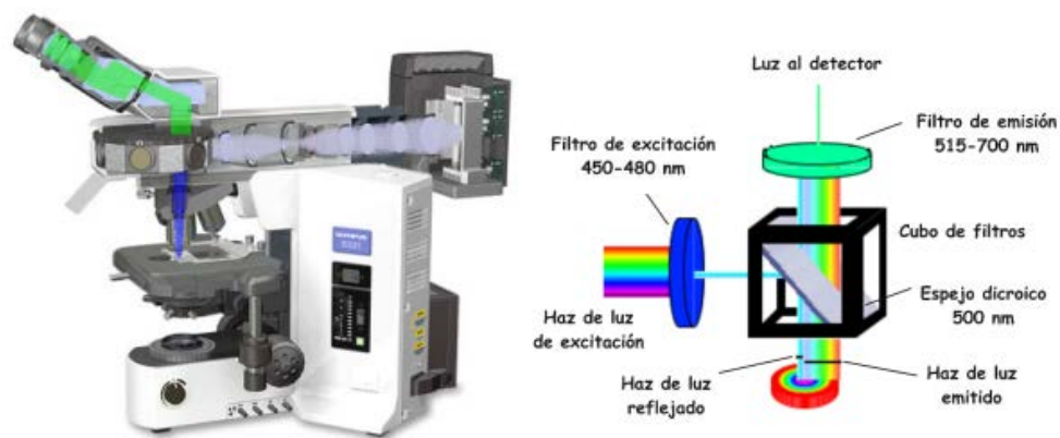
Fig. 3-87. Izquierda: La luz emitida por una lámpara de mercurio, ubicada en la caseta de la lámpara fluorescente, atraviesa el camino óptico del brazo fluorescente hasta alcanzar el soporte de filtros ubicado en el camino óptico del microscopio. Si el filtro de excitación está diseñado para dejar pasar las longitudes de onda entre 450 y 480 nm, la luz reflejada será de color azul. Esta luz incide sobre la muestra y se refleja nuevamente hacia el cubo, atravesando el espejo dicroico y finalmente el filtro de emisión. Si este último deja pasar las longitudes de onda cercanas a los 500 nm, la luz que se dirige al detector u ocular será de color verde. Derecha: Esquema del cubo de filtros que estaría actuando en la figura de la izquierda.
