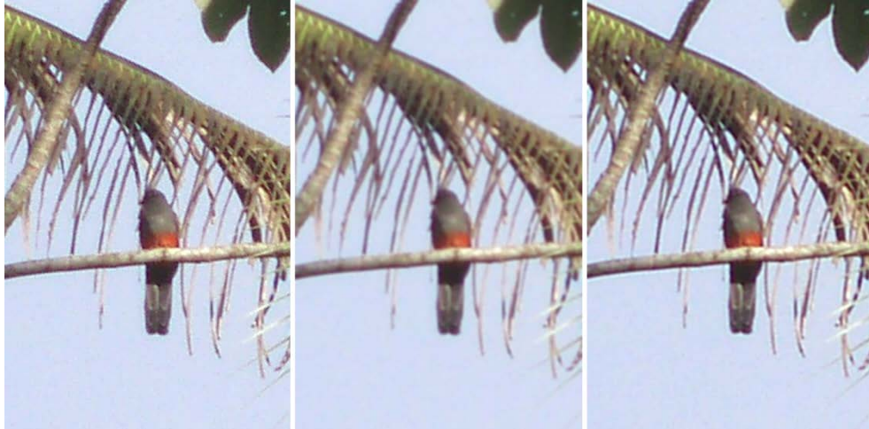
Fig. 4-30. La imagen original (izquierda) muestra el efecto del ruido de la cámara fotográfica alrededor de los objetos y en el fondo (puntillado blanco). Al aplicar un filtro Gauss (centro) con un kernel de 7 \times 7 , el ruido desaparece. Si sobre la imagen filtrada se aplica un filtro Unsharp (derecha), se restablece la fidelidad inicial, pero sin el ruido de fondo.
