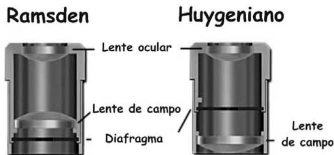
Fig. 3-83. Ocular positivo (izquierda) y negativo (derecha).
