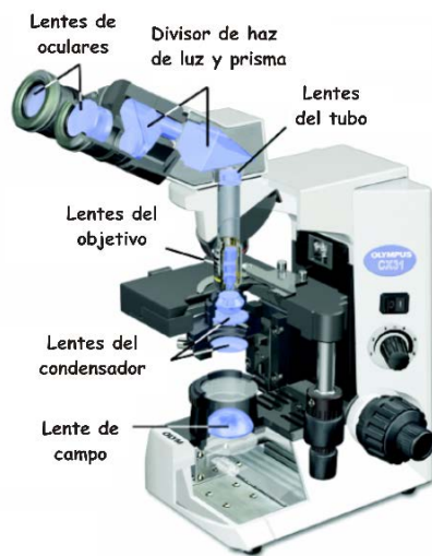
Fig. 3-50. Estructura del microscopio de luz, mostrando distintos tipos de lentes interpuestas en el camino óptico.
