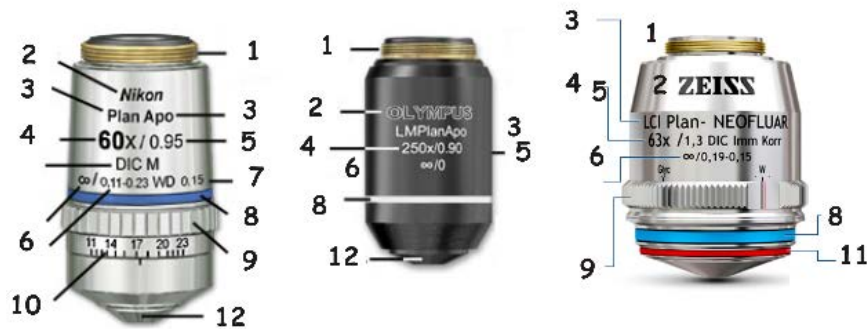
Fig. 3-52. Los objetivos muestran inscripciones en su superficie, que siguen los estándares de la Sociedad de Microscopía. Referencia de los componentes e inscripciones: 1. Rosca de montaje al revolver; 2. Fabricante; 3. Corrección de aberraciones; 4. Magnificación; 5. NA; 6. Longitud del tubo y grosor del cubreobjetos; 7. Distancia de trabajo (del inglés, "working distance" - WD); 8. Código de color de la magnificación; 9. Anillo de corrección (diafragma iris); 10. Collar de corrección (espesor del cubreobjetos); 11. Código de color del medio de inmersión; 12. Caja de la lente frontal.
