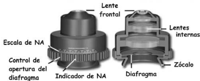
Fig. 3-80. Condensador acromático/aplanático.
