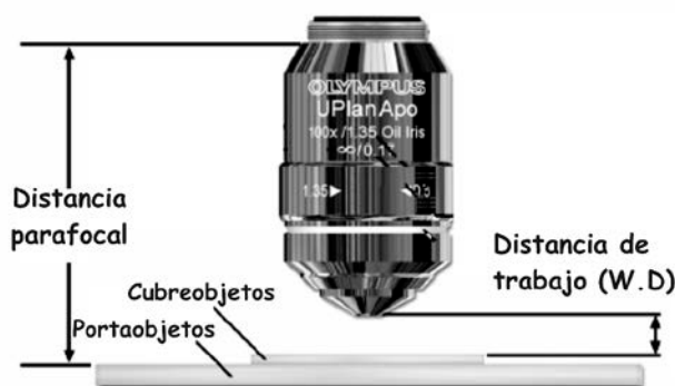
Fig. 3-55. La distancia de trabajo (WD) es la que establece la máxima separación permitida entre el objetivo y la muestra para no perder foco y resolución.
