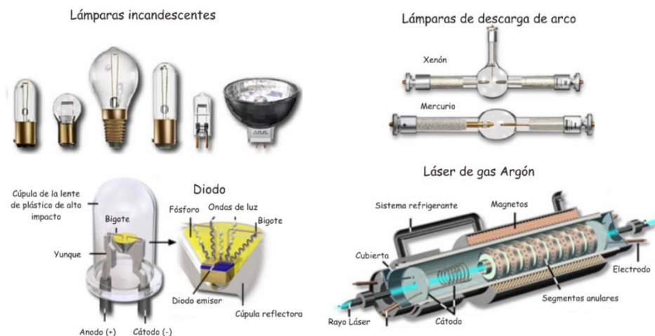
Fig. 3-19. Diferentes fuentes de luz: lámparas incandescentes, descarga de arco o gas, diodos y láser.
